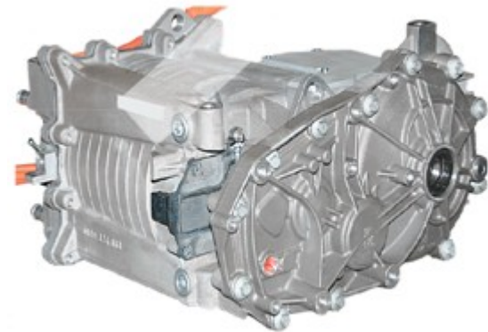
E-Motor mit Getriebe als Hauptantrieb
